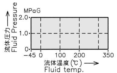
図1-5 バランスシール使用温度・圧力範囲
